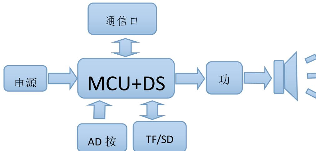
芯片选用的是 SOC 方案，集成了一个 16 位的 MCU，以及一个专门针对音频解码的 aDSP，采用硬解码的方式，更加保证了系统的稳定性和音质。小巧的封装尺寸更加满足嵌入其它产品的需求
