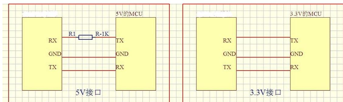
芯片的串口为 3.3V 的 TTL 电平，所以默认的接口的电平为 3.3V。如果系统是 5V。那么建议在串口的对接接口串联一个 1K 的电阻。这样足以满足一般的要求，如果应用于强电磁干扰的场合，请参考“注意事项”的说明。芯片在 5V 和 3.3V 的系统中均正常的测试过，一切正常。均在采用的是直连的方式，并没有串 1K 的电阻。
